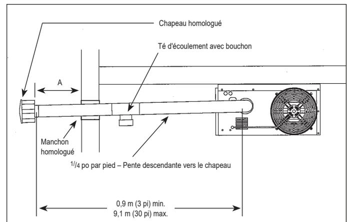
C8. Lorsqu'un chapeau de cheminée est situé sous un avant-toit, la distance du porte-à-faux ne doit pas dépasser 61 cm (24 po). Les dégagements par rapport aux surfaces combustibles d'un conduit d'évacuation extérieur doivent être de 30 cm (12 po) au minimum. Consultez le National Fuel Gas Code pour les exigences additionnelles relatives aux avant-toits ayant des ouvertures de ventilation.
