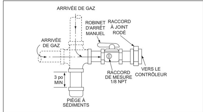
① En position OFF, la manette du robinet d'arrêt de gaz doit être perpendiculaire au tuyau.
